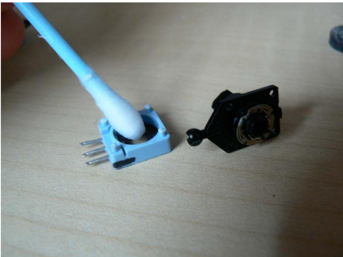
Bueno, pues ya lo tenemos limpio, ahora solo queda abrir un poco mas, si quereis, las patillas metalicas de contacto para asegurarnos una buena conexión y lo volvemos a montar, encajando las patillas en los agujeros. Y para que no se abra, lo sellamos con un poco de cola caliente, por aquello de que si en un futuro tenga que volver a abrirlo, no sea muy problemático.
